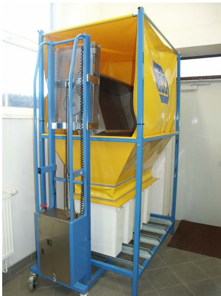
Ryc. 17. Urządzenie rozładunkowe skrzyń szafy wyluszcarskiej. (fot. R. Sienkiewicz)
