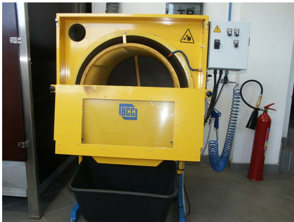
Ryc. 18. Dwufunkcyjny bęben odskrzydlający nasiona. (fot. R. Sienkiewicz)
